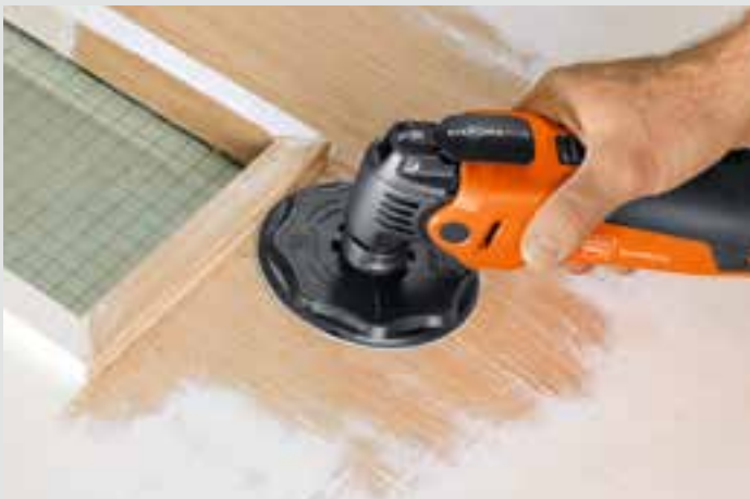
Il grande platello tondo sostituisce eventuali levigatrici aggiuntive come le levigatrici ad eccentrico o orbitali.
