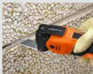
Coltello lungo per giunti molto profondi.
