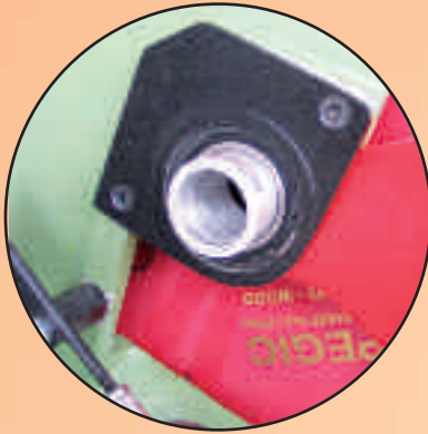
PROTEZIONE LAMA con cuscinetto BLADE PROTECTION with bearing
