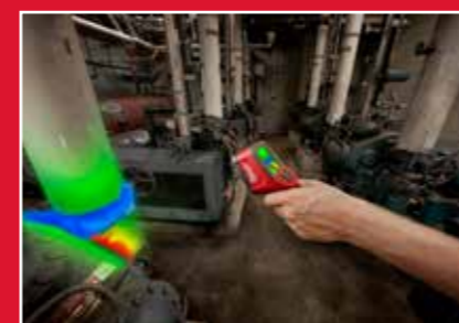
Ampio campo di temperature rilevate (da -10°C a 330°C)
