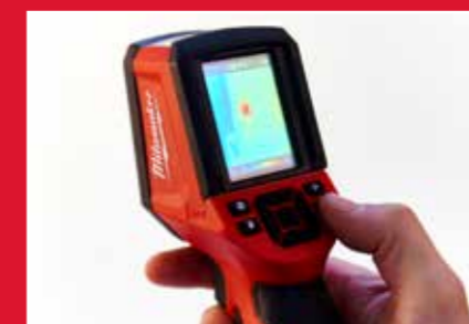
Identificazione automatica della temperatura più alta e più bassa
