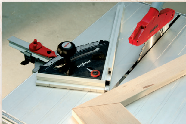
... o modificare l'impostazione della battuta. Il risultato: tagli e giunzioni a 90° perfetti.
