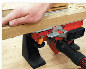
I trucioli vengono aspirati in maniera semplice.
