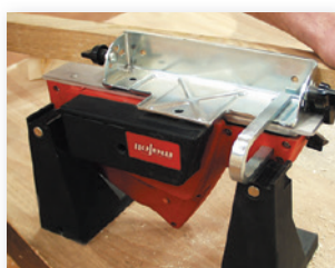
Pialletto MHU 82 con set da banco e cuffia di protezione.
