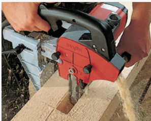
Mortase di diverse dimensioni fino a 100 mm con la LS 103 Ec.
