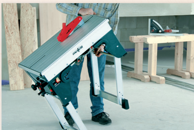
Il supporto /Quickstand\ è facilmente ripiegabile in qualche secondo per facilitare il trasporto dell'ERIKA 85 Ec.
