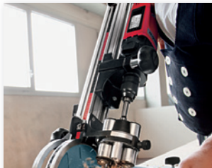
Trapano HB 1 E con la stazione di foratura MAFELL.
