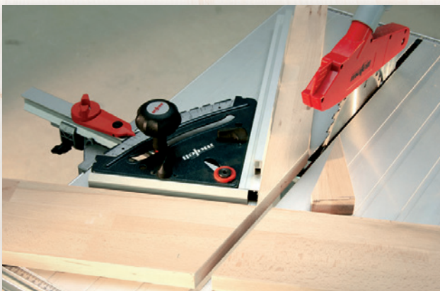
La battuta multifunzionale consente di effettuare due tagli obliqui senza cambiare...
