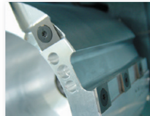
La nuova testa portafresa con le sue placchette ribaltabili in metallo duro comporta un'insuperabile capacità di truciatura, migliorano nel contempo l'evacuazione dei trucioli.
