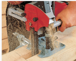
La LS 103 Ec con sistema di squadre FG 150 per perforazioni fino a 150 mm.
