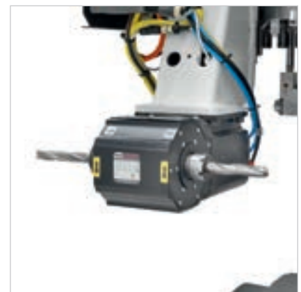
Motore orizzontale a 1 o 2 uscite dedicato a scassiserrature e lavorazioni orizzontali.
