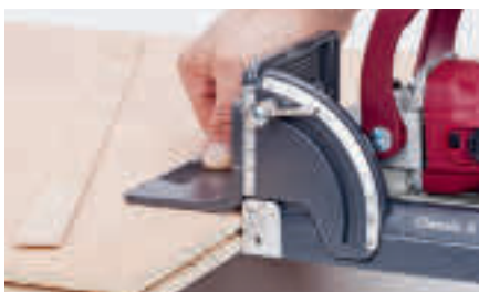
Fresare scanalature continue per giunzioni a fresata oppure a molla, standard von Fresa in HW da 4 mm
