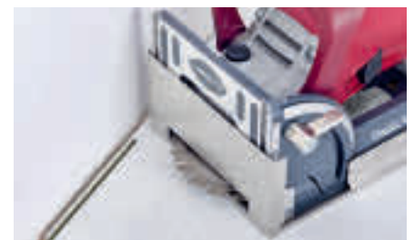
Taglio di perline taglio di perline a distanza per soffittature, parquet o pavimenti laminati, Pattino scorrevole con Sega circolare in HW
