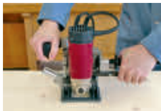
Fresatura del rattoppo
