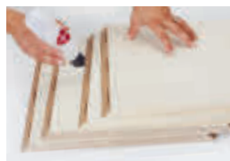
2. Spargere la colla nella fresata
