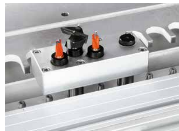
Gruppi per cerniere Per una maggiore polivalenza della macchina, è possibile equipaggiare i mandrini con varie tipologie di testine opzionali in grado di realizzare delle pratiche sedi per cerniere.
